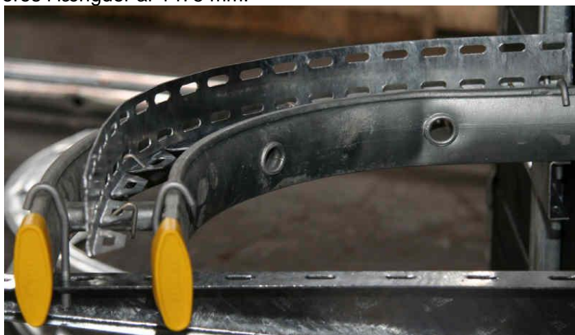
Fig. . Den flexible deleskinne håndbukkes til ønsket radius og monteres med CDS beslag i stigeformstykket (sving/t-stykke/kryds etc.) For anvendelse af CDS beslag se side 11 i denne vejledning.
