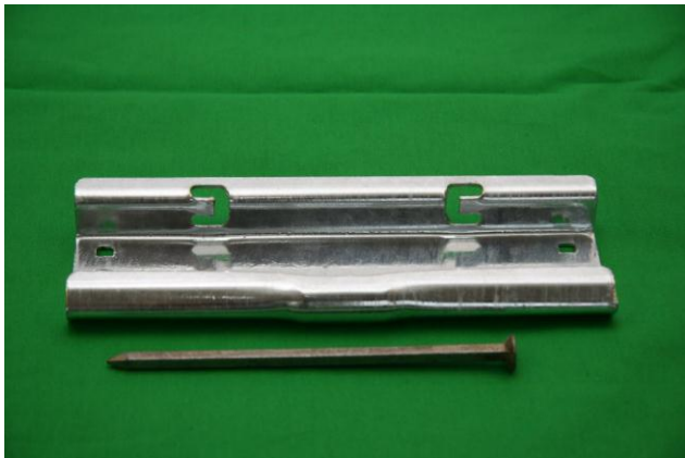
Fig. 1.: Lasken består af en komponent, hvori der er udformet 2 låseflige. Sømmet ved siden af (55/160), kan anvendes til at sætte lasken på plads på stigen, og til at vejle låsefligene. En skruetrækker kan også bruges.
