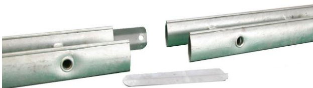
Fig.1 Laskerne placeres i enderne på stigen vanger. SLG: 2 stk. pr. samling
