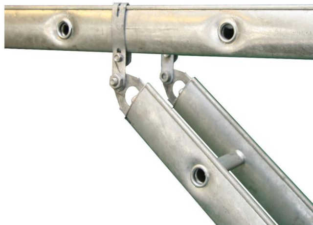
Fig. 2.: SLK-lasker placeres i vangerne på tilstødende stige (se ovenfor) og påboltes vangebeslaget med 10x20 bolt-sæt
