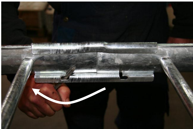
Fig. 5: Låsefligene vejnes ved at sømmet skubbes mod låsefligen parallelt med stigen vange.
