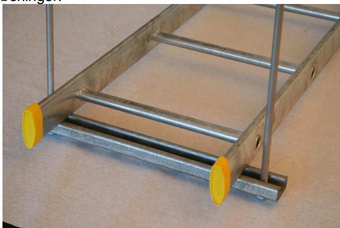
Eksempel: Løsningen kan eksempelvis anvendes til ophæng af kabelstiger, hvor pladsen er trang. Her anvendes vægskinner istedet for konsoller. Det giver en billig robust løsning. Løsningen har dog den ulempe i.f.t. ophæng via Konsoller/Pendler, at kablerne skal syes gennem gevindstængerne.
