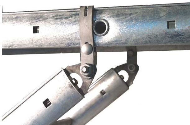
Fig. 1.: Vangebeslagene (VAB) presses ind over vangerne, og spændes fast med 6x16 laskebolt-sæt.
