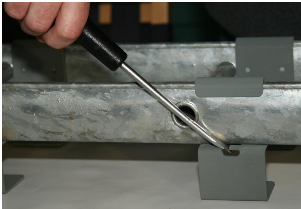
Fig. . HVIB beslaget sættes ind over stigen vange. Beslaget trækkes til og låses med et søm på samme måde som laskerne KS-LA/KS-SLK (se side 3). Hvis stigen monteres vertikalt (lodret) skal HVIB beslaget monteres lige under et af stigen trin, så stigen hviler på beslaget. Beslaget kan fixeres på stigen inden der bores gennem beslaget ind i væggen. Derved undgås opmærkning, og montagetiden reduceres. Ved normal belastning, skal beregnes 1 HVIB pr. meter (minimum 4 stk. og altid lige antal (1 stk pr. vange)). HVIB vægbeslag 1.pr.m (lige antal)
