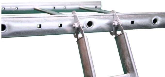
Fig.2.: UK-kroge krænges ind over vangen på tværgående stige og møtrikkerne tilspændes.
