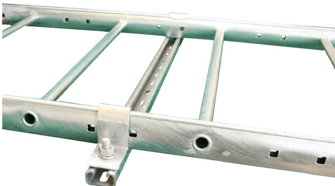
Fig. 1.: VVIB kan monteres direkte på vægskinner med T-bolt-sæt. Her kan VVIB naturligvis også monteres indvendigt i stigen. Da T-bolte og vægskinneprofil er identisk med dem som anvendes til loftpendler, kan montage med VVIB også udføres direkte på loftpendel.
