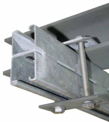
Eksempel 3. Dobbelt vægskinnne 50V/DLO monteret i Ståldrager med stålbjælkebeslaget SBBS og gevindstænger.
