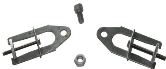
Fig. 1.: SLK-laskerne forspændes (ca. 15mm gevind) inden de skydes ind i vangerne på stigen. Et let dask med en plastic hammer får lasken til at låse. (Der skal kun anvendes fastnøgle på låsebolten, hvis SLK-lasken skal afmonteres)
