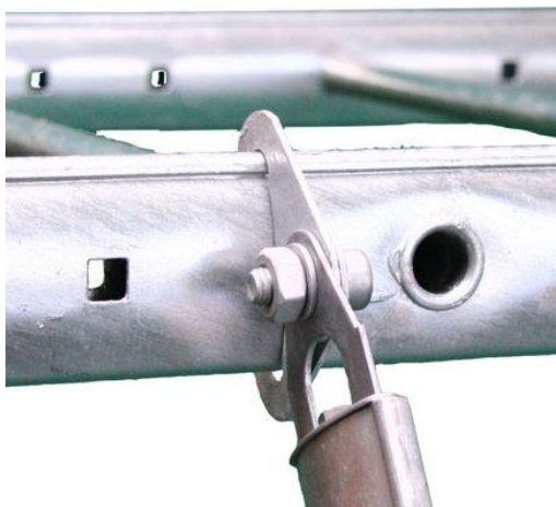
Fig. 1.: SLK monteres i vangerne på stigen. 2 stk. UK påmonteres hver SLK med M10x20 boltsæt. Bemærk at UK-kroge skal vende hver sin vej.
