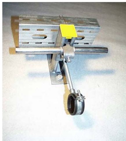
Fig. 1. BAK100L51 monteret på pendel (DLO200) direkte på væg. På undersiden af pendlen er monteret rør i rørbøjle type R1G og rørophæng fæstnet i 10mm spormøtrik.
